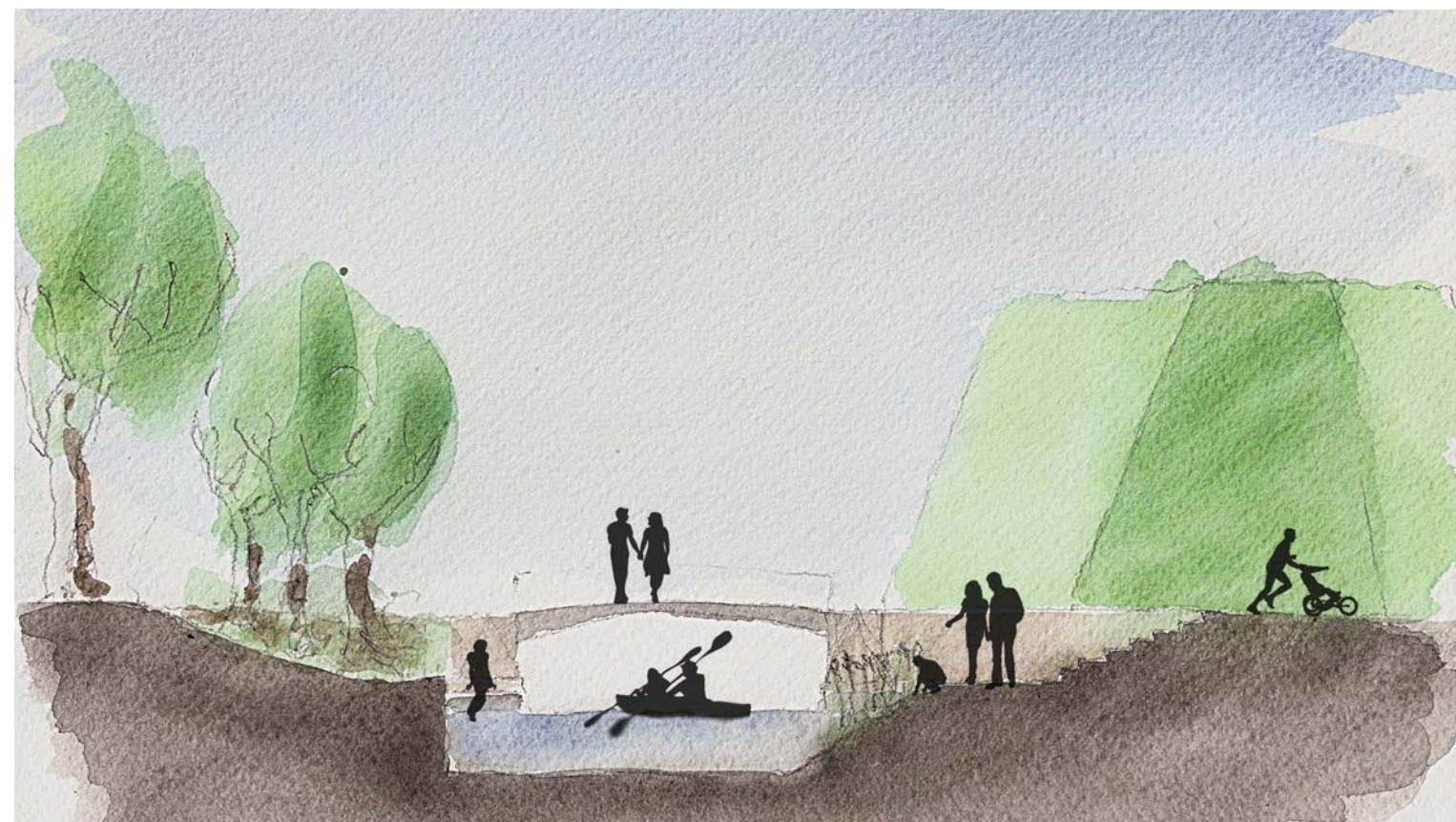
Typisk snit gennem kanalen med stier i forskellige niveauer, mulighed for at komme helt ned til vandkanten og broer til at komme over kanalen.
